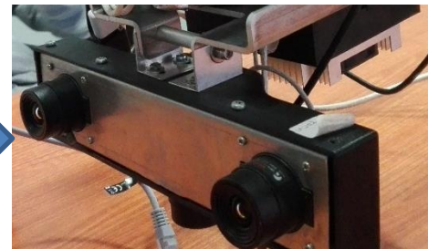
Camere stereoscopiche + camera per path following e pc elaborazione video
